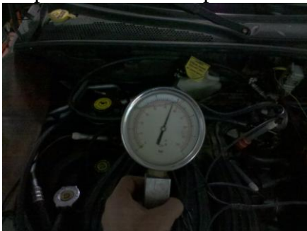
La presión de combustible en norma
